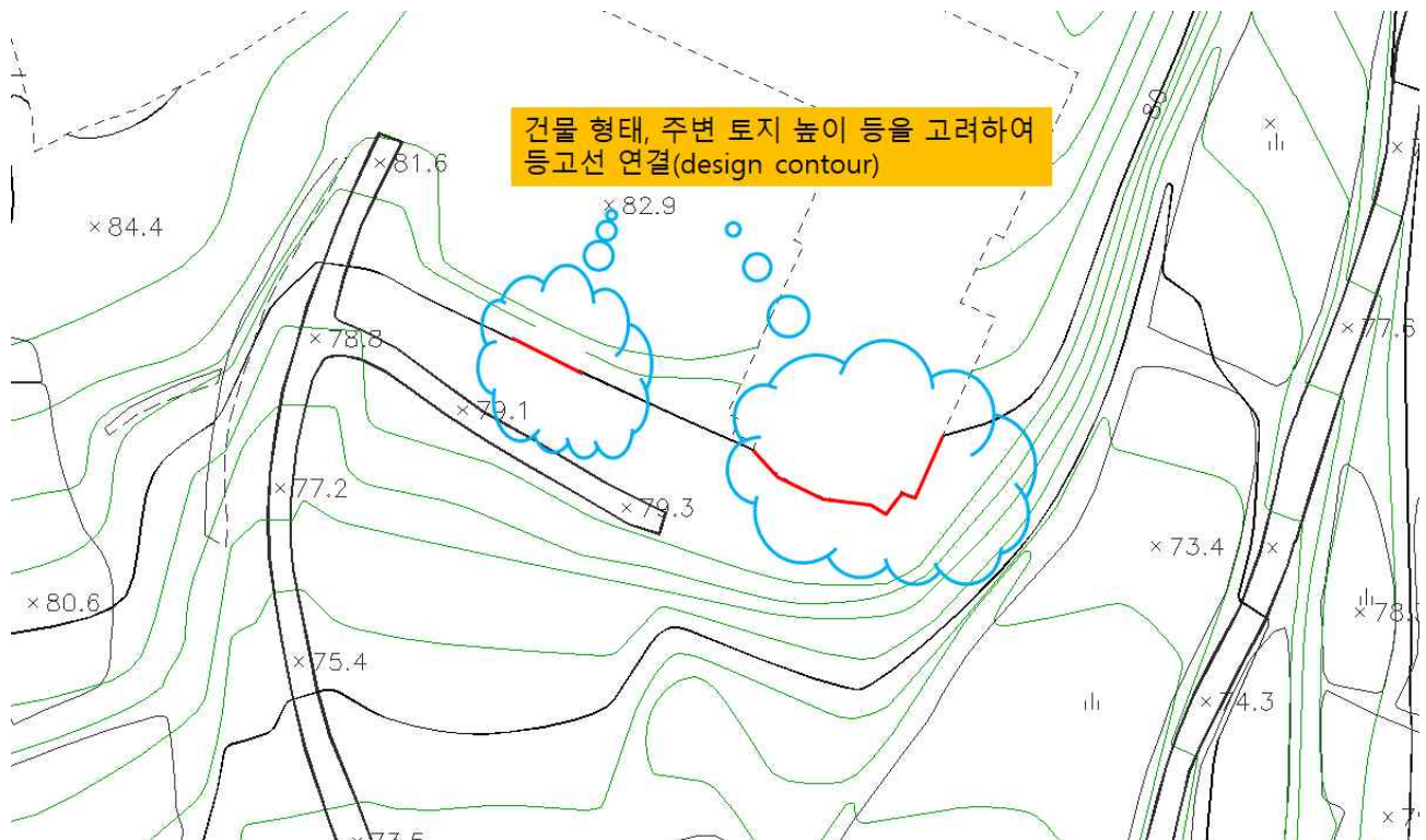
그림. design contour를 찾아 등고선을 연결하는 경우 예시
